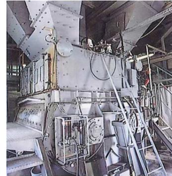
油圧可変速2軸強制練ミキサ
