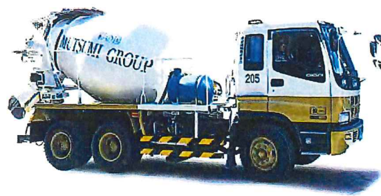
生コンクリート運搬車
